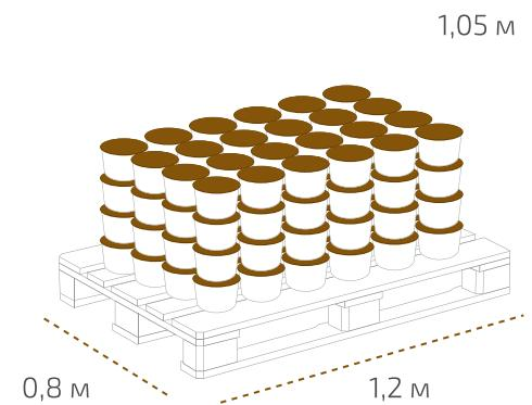
Допускается транспортировка и хранение герметиков «Wepost Wood» и «Wepost Wood Profi» при температуре не ниже минус 5 °C.
